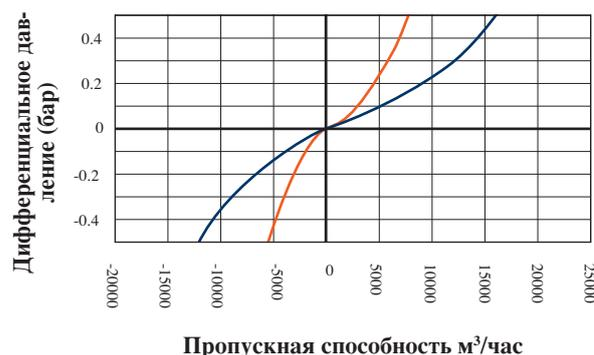
**График пропускной способности клапана в автоматическом режиме**
